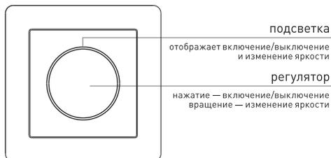
Рисунок 2. Органы управления и индикации.
